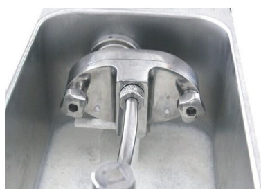
Figura 6-5: la mezcla no sale por los agujeros chicos de la bomba de aire
