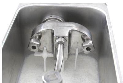
Figura 6-4: mezcla saliendo por los agujeros chicos de la bomba de aire
